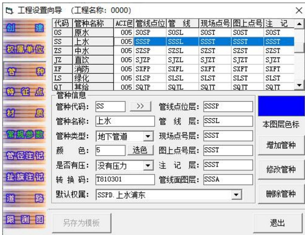
1) 新增管种：输入相应的管种设置信息，按“增加管种”即可，新增的管种下还没有特征点定义，请在特征点设置中将相应的特征点加入到该管种中（参见 3、特征点设置）。
