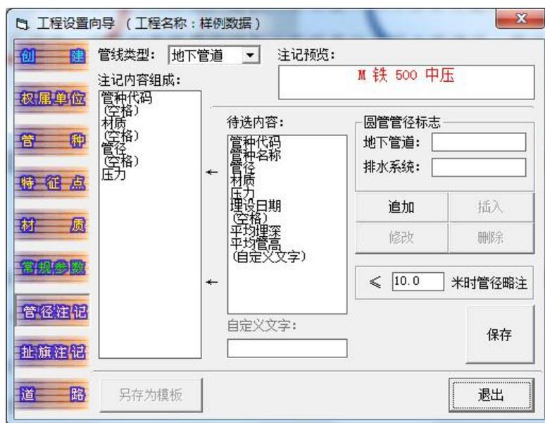
在上方管线类型栏选择相应的管线类型，此后的设置即保存到该管种类型下。
