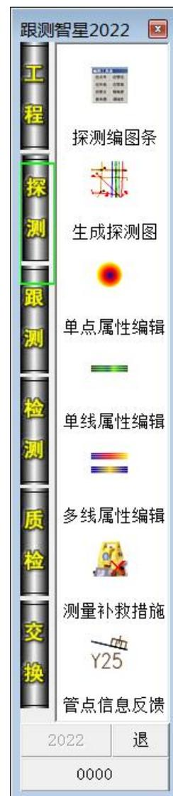
第三步、按“生成探测图”按钮生成全部管线图，直至提示“成图完成！”。
