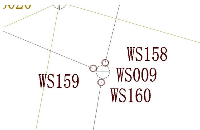
窰井 WS009 修建完成后，测量员又对窰井进行了实测，其地面高程取用井盖高程。
